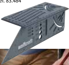
ESCAIRE 3D Aquesta eina de marcatge permet prendre mesures fàcilment i transferir-les a bigues, peces de treball tridimensionals. Amb límits per a angles de 45° i 90° i un transportador d'angles entre 0° i 90°. Proporciona un indicador per a línies paral·leles. També equipat amb un calibrador de diàmetres.
