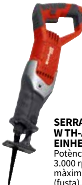
SERRA DE VOGIR ELECTRÒNICA TC-JS 80/1 EINHELL Potència de 550 W, acció pendular, velocitat: 800-3.000 min-1. Profunditat del tall: fusta, 80 mm; ferro, 10 mm; plàstic, 20 mm. Tall diagonal: màx. 45°.
