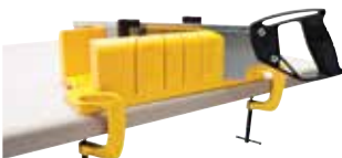
SERRA DE BIAIXOS DE PLÀSTIC 1-20-600 STANLEY Amb cos de matèria sintètica molt resistent. Per a talls amb angles de 45°, 90° i 22,5°. Subministrada amb un xerrac de 355 mm, d'acabat fi (13 DPP) i dentat HP.
