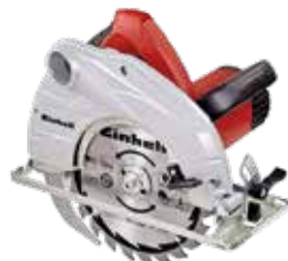
SERRA CIRCULAR TC-CS 1400/1 EINHELL Potència: 1.400 W, rpm: 4.800 rpm. Profunditat de tall a 90°: 65 mm. Profunditat de tall a 45°: 45 mm. Disc de serra: diàmetre 190 x 20 x 2,5 mm. 24 dents.
